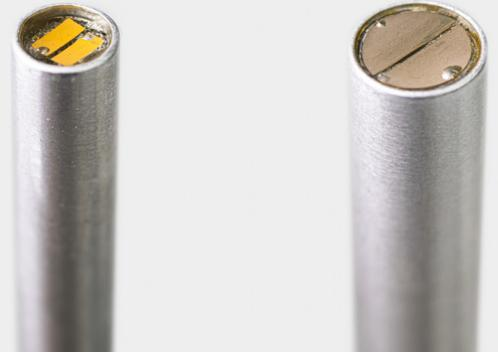
Il s'agit matériellement d'un tube creux contenant un élément en graphite traité qui fonctionne sur le principe de la différence de potentiel entre l'électrolyte remplissant le corps de sonde et les ions chlorures de la sueur.
